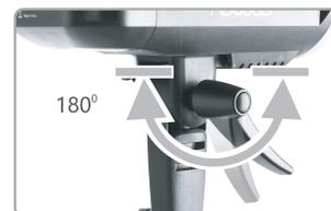
1、手柄固定件未拔出状态下,顺时针锁紧,逆时针旋松。
